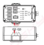
打开 GOOSKY T8 遥控器,飞机上电连按 3 次(BIND)按键 等蓝灯快闪,遥控器靠近飞控小于 1 米距离,蓝灯常亮飞控通 过自检,对频完成;
